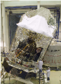
Le satellite Herschel dans la salle d'intégration. L'équipe GEMO du LERMA a construit le canal 1 de l'instrument hétérodyne HIFI, en collaboration avec l'IRAM Grenoble.
