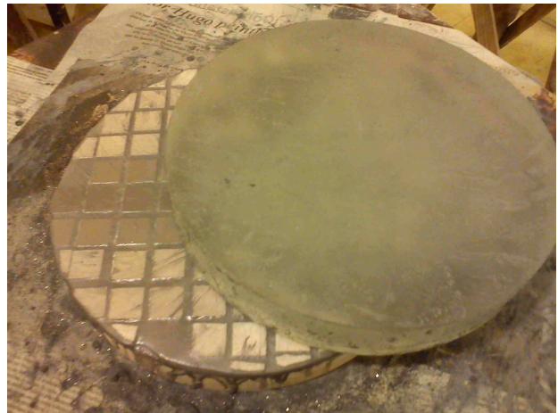
Miroir : outil phase d'ébauchage fait de plâtre et carreaux de céramique, abrasif : carborundum.
