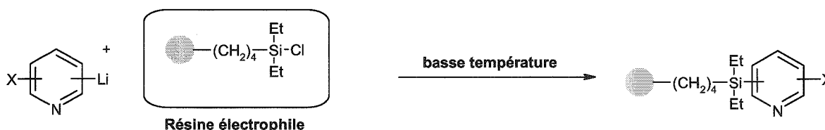
Schéma 163 : Stratégie de greffage d'une entité pyridinique sur polymère.
