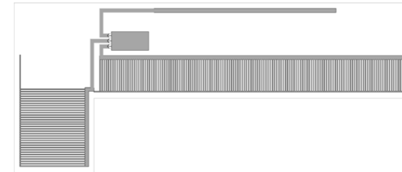
Plan des conduits et tube en carton noyés dans le béton. Plans informatisés réalisés par HINANT .A avec CAPS.C et NEYRINCK T.
