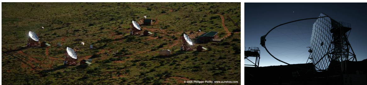
(a) Le système stéréoscopique H.E.S.S. constitué de 4 télescopes. (b) Le télescope de 17 m de MAGIC .
