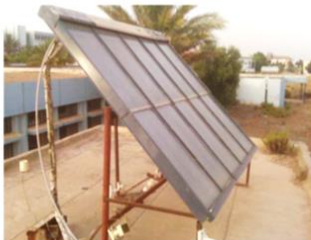
Figure IV-6 : Collecteur solaire thermique plan (Gacem, 2013)
