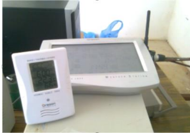
Figure IV-13 : Mini station météorologique (Tennah, 2013)
