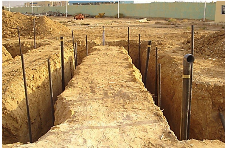
Figure II-16 : Image expérimentale de l'emplacement des thermocouples le long du conduit (Benhamza et al., 2016)
