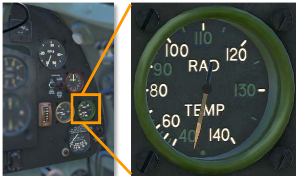
Figure 75: thermomètre du système de refroidissement
