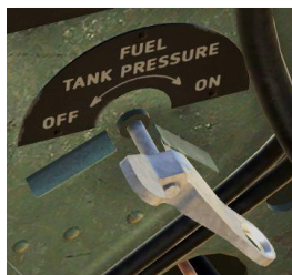
Vanne de pressurisation du réservoir
