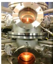
Figure 1 : Cliché et schéma de fonctionnement du réacteur de pyrolyse laser double étage
