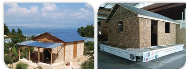
Premier prototype de TCLA (Techniques de Construction Locales Améliorées) – / Essai sur table vibrante au FCBA – C. Belinga
