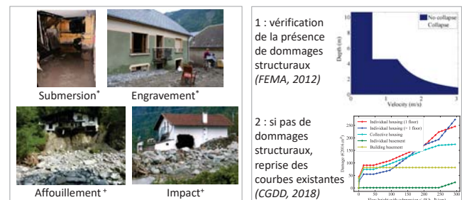
Processus d'endommagement avec dommages non-structuraux* et structuraux*
