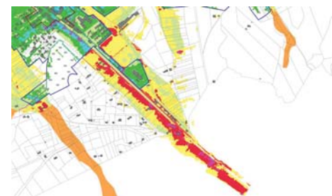
Exemple d'un zonage réglementaire annexé à un PLU, combinant cartographie HGM et modélisation 2D
