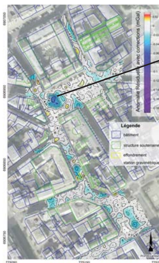
Anomalie gravimétrique résiduelle après correction des effets anthropiques © BRGM
