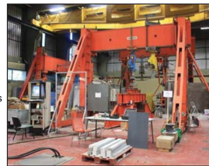
Essai pseudo-dynamique Portique en béton armé vieilli
