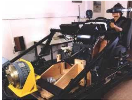
Figure 7B.17: Simulation de conduite en réalité virtuelle immersive - simulateur SHERPA. © PSA
