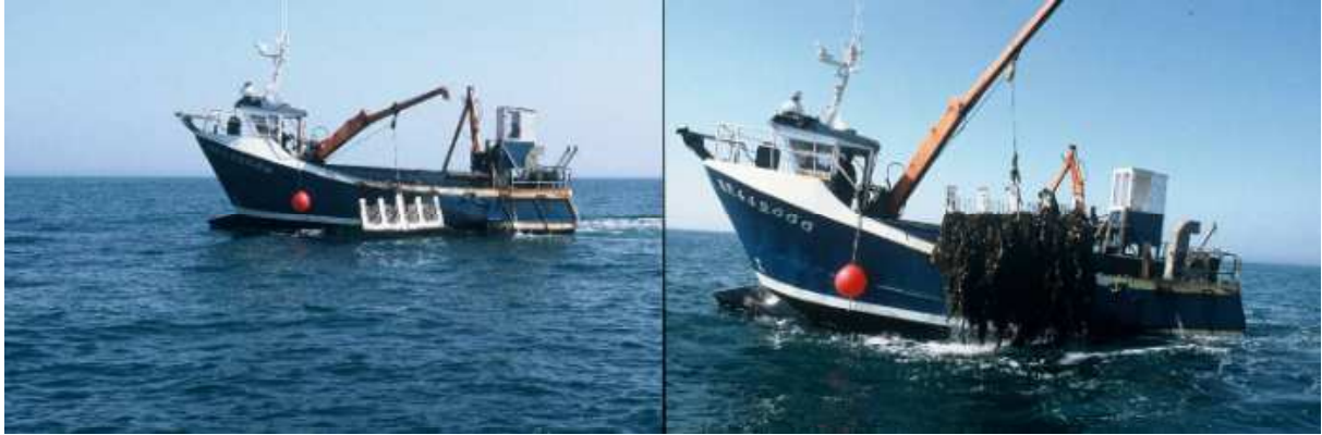
Figure 7. Photographies d'un bateau équipé pour la récolte de Laminaria hyperborea avec un peigne métallique qui permet d'accrocher les algues et de les remonter sur le bateau. Un système de coupe rejette les frondes pour ne conserver que les stipes (technologie développée par la Norvège).
