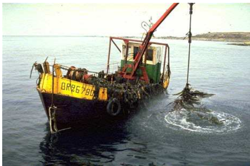
Figure 6. Photographie d'un bateau goémonier : récolte des laminaires avec le « scoubidou ». © Ifremer Olivier Barbaroux.
