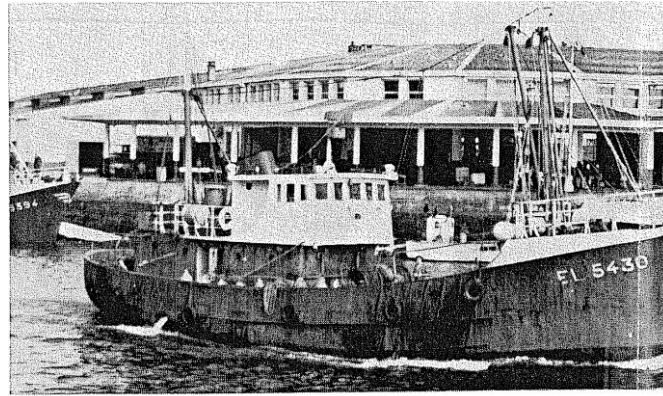
Première unité ételloise à pratiquer le filet maillant, voici le « Paciflore » sortant du port de Lorient, de long, construit aux chantiers de la S.I.C.C.Na à St-Malo et doté d'un moteur Baudouin de 400 ch et de
