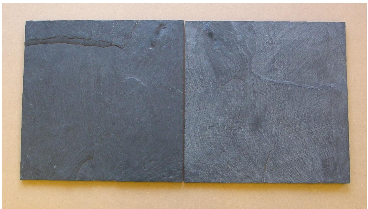
1991 ardoise de Martelange fendue en deux, « Livre » ouvert, une griffée
