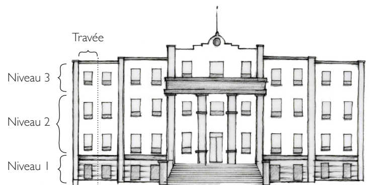
Élévation de bâtiment institutionnel
