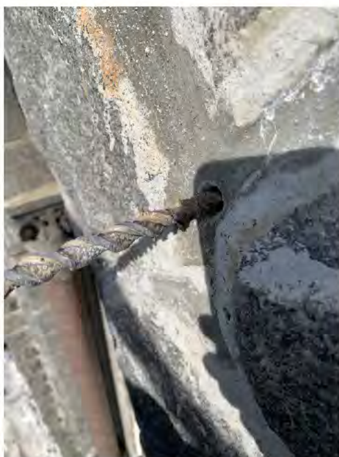
Photo 21 : Présence d'eau sur la mèche lors du forage Z10-06
