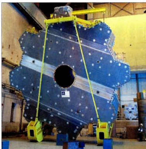
L'une des enceintes à vide de 11 m destinées aux deux aimants toroïdaux des bouchons d'ATLAS; elle est représentative de la taille des grandes pièces qui seront descendues dans la cavité au cours de l'installation.
