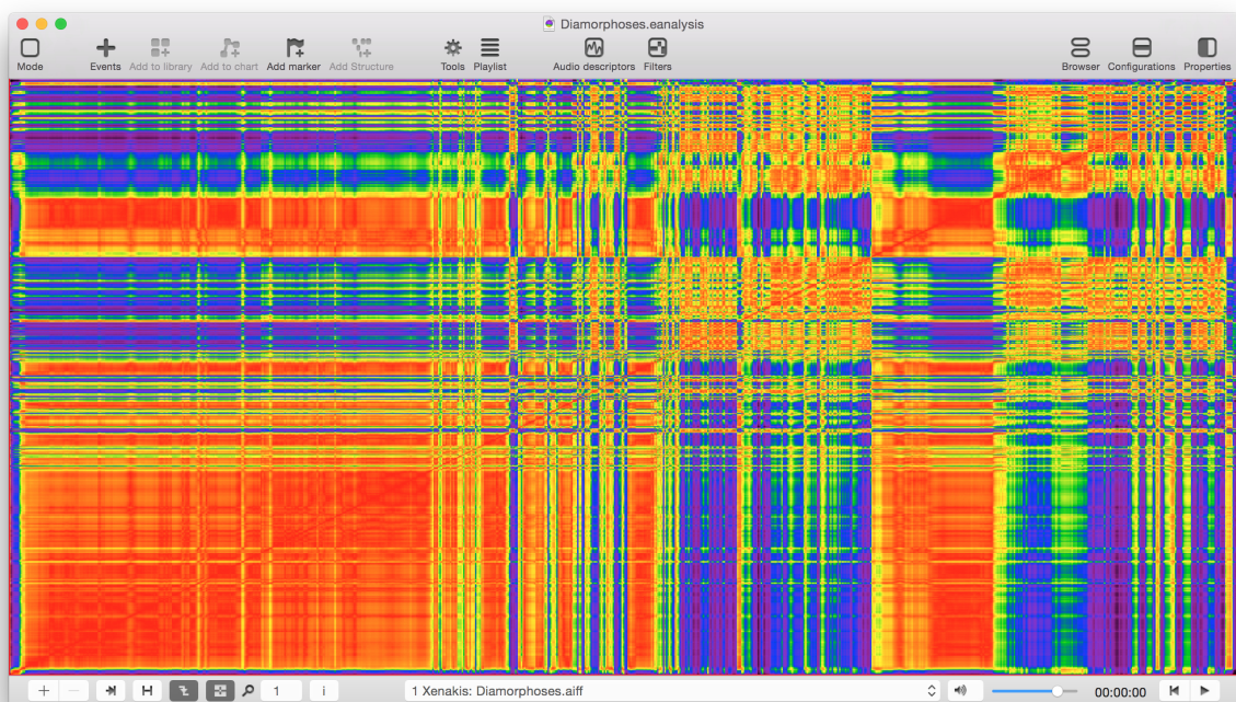
FIGURE D.4 – Exemple de matrice d'auto-similarité calculée à partir du spectral rolloff , de la variance spectrale et de l'inharmonicité.
