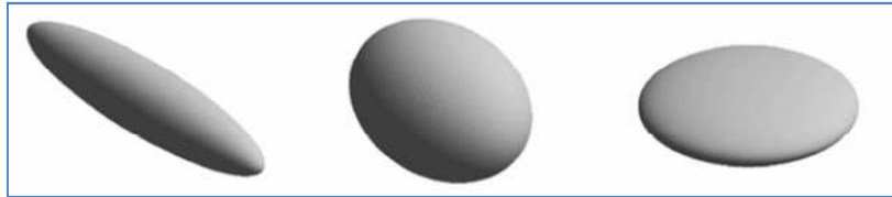
Figure 29 : Forme de l'ellipsoïde en fonction du type de diffusion. A droite, diffusion anisotrope, ellipsoïde en forme de cigare. Au centre, diffusion isotrope, ellipsoïde sphérique. A gauche, diffusion privilégiée dans un plan : ellipsoïde en forme de galette. D'après (Tournier et al., 2003).
