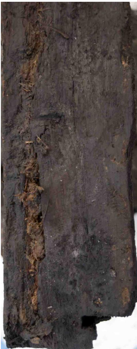
Fig.111 – Can d’un bordé sur lequel on remarque la présence de restes de produits de calfatage.
