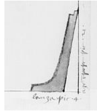
Fig.180 – Elancement et hauteur de l'étrave de la nave de Z. Trombetta (f°45v)
