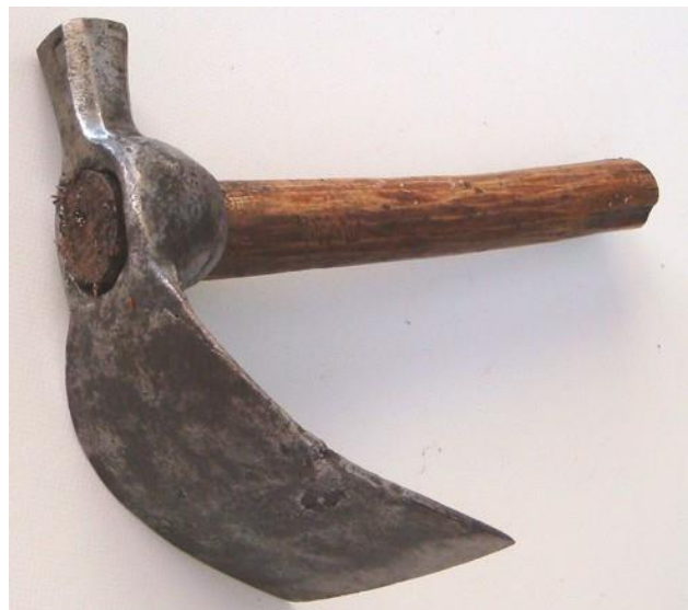
Fig.24 – L' herminette, un outil tranchant essentiel dans le façonnage des pièces
