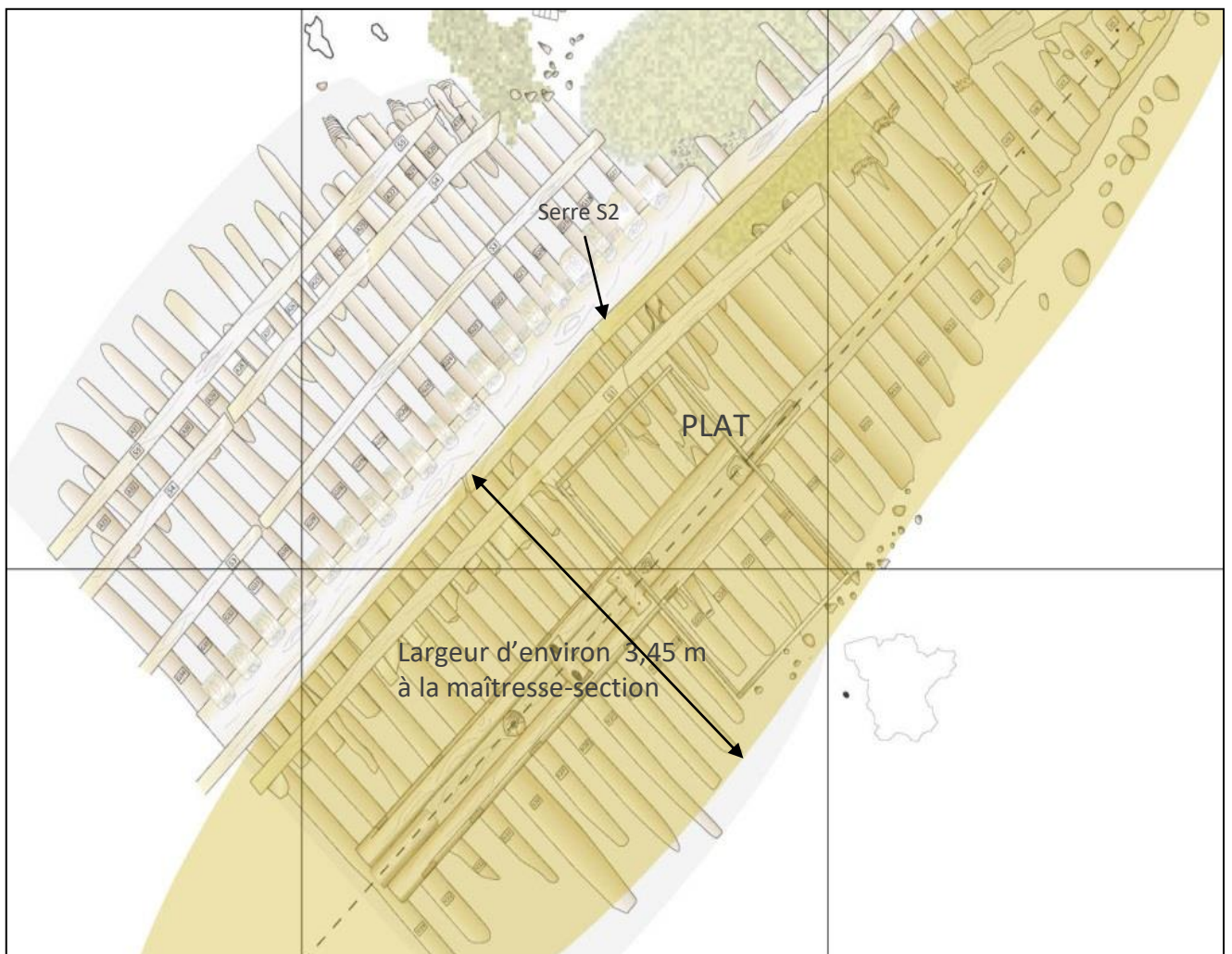
Fig.159 – Représentation de la surface du plat de l'épave de la Mortella III
