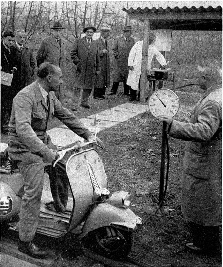
Le canton de Zurich vient de rendre obligatoire pour tous les véhicules un examen au cours duquel est contrôlé le bruit produit par ces derniers. Tous les engins qui dépassent la limite fixée devront être révisés.
