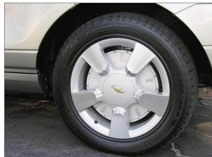
Les roues arrière du Sequel disposent chacune de leur propre moteur électrique.
