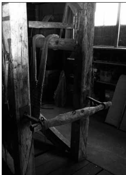
Fig. 12. Barre arrière en position « gros animaux » (n° 8, fig. 5).
