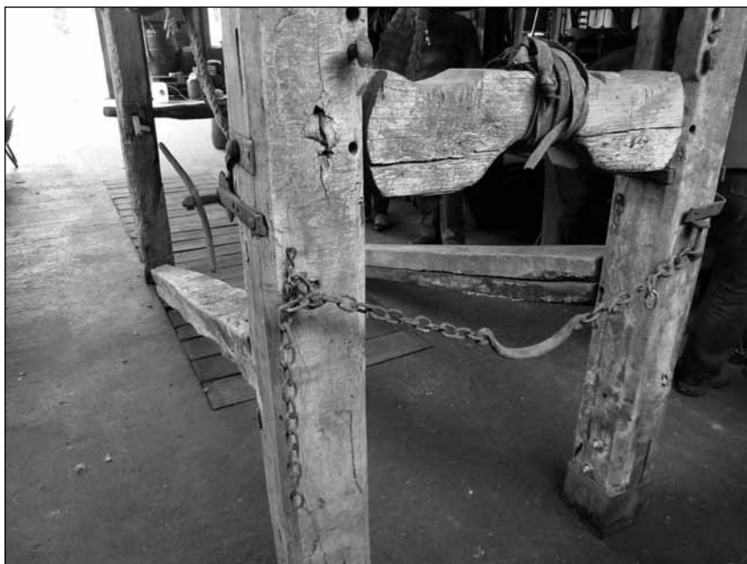
Fig. 10. Traverses basses vues de l'avant (n° 4, fig. 5), joug (n° 6, fig. 6) et étrier pour immobiliser la tête (n° 7, fig. 6).
