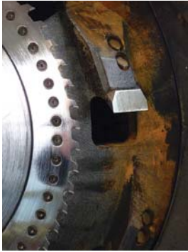
FIGURE 1.23 – Tête de slabber à couteaux fragmentés et à portion de scie circulaire.
