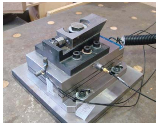
FIGURE 3.52 – Disposition des accéléromètres permettant de déterminer le comportement dynamique de la platine par sonnage.
