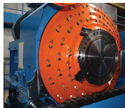
FIGURE 1.21 – Slabber à copeaux en spirale (Source : www.se-saws.com ).
