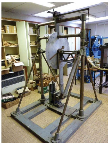
FIGURE 3.8 – Pendule de Chardin du LaBoMaP (Longueur du bras : 1,2 m. Masse du bras : 36 kg. V_c \simeq 420 \text{ m.min}^{-1} ).
