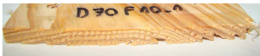
FIGURE 3.27 – Surface coupée d'une éprouvette de douglas ( H = 40\% , GD = 70^\circ , h = 10 mm).
