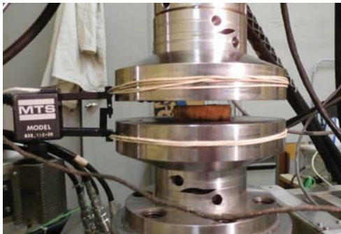
FIGURE 2.22 – Montage de l'extensomètre utilisé pour les essais de compression en condition quasi-statique.
