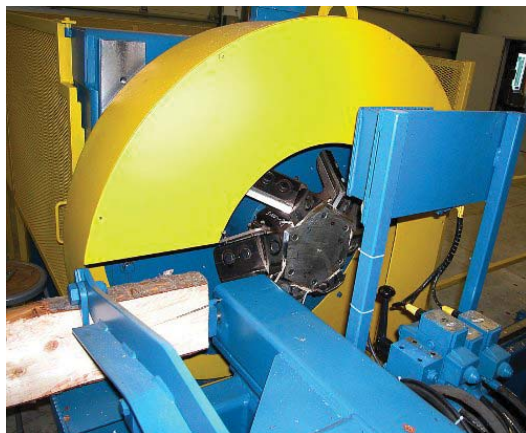
(a) Slabber à couteaux longs et couteaux de finition [Houziaux 08].
