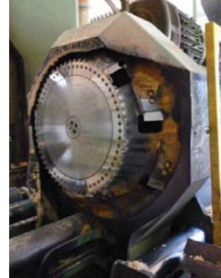
FIGURE 1.19 – Slabber à plusieurs rangées de copeaux. La géométrie de cette tête est complètement décrite en Annexe B.
