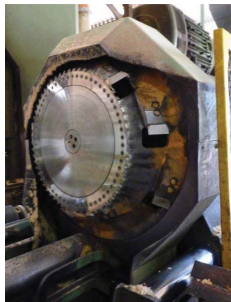
(b) Slabber à couteaux fragmentés et segments de scie circulaire CT700 (LBL-BRENTA-CD).
