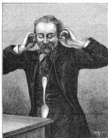
Fig. 4. Conductibilité du son par les corps solides.
