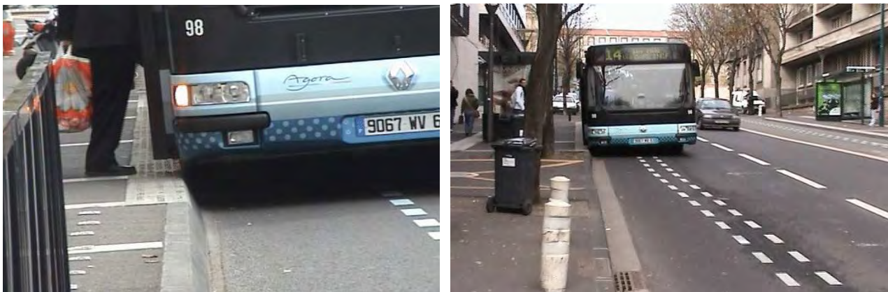
Photos 3 et 4 : accostages avec le dispositif de guidage optique inactif aux stations Carnot et Faculté
