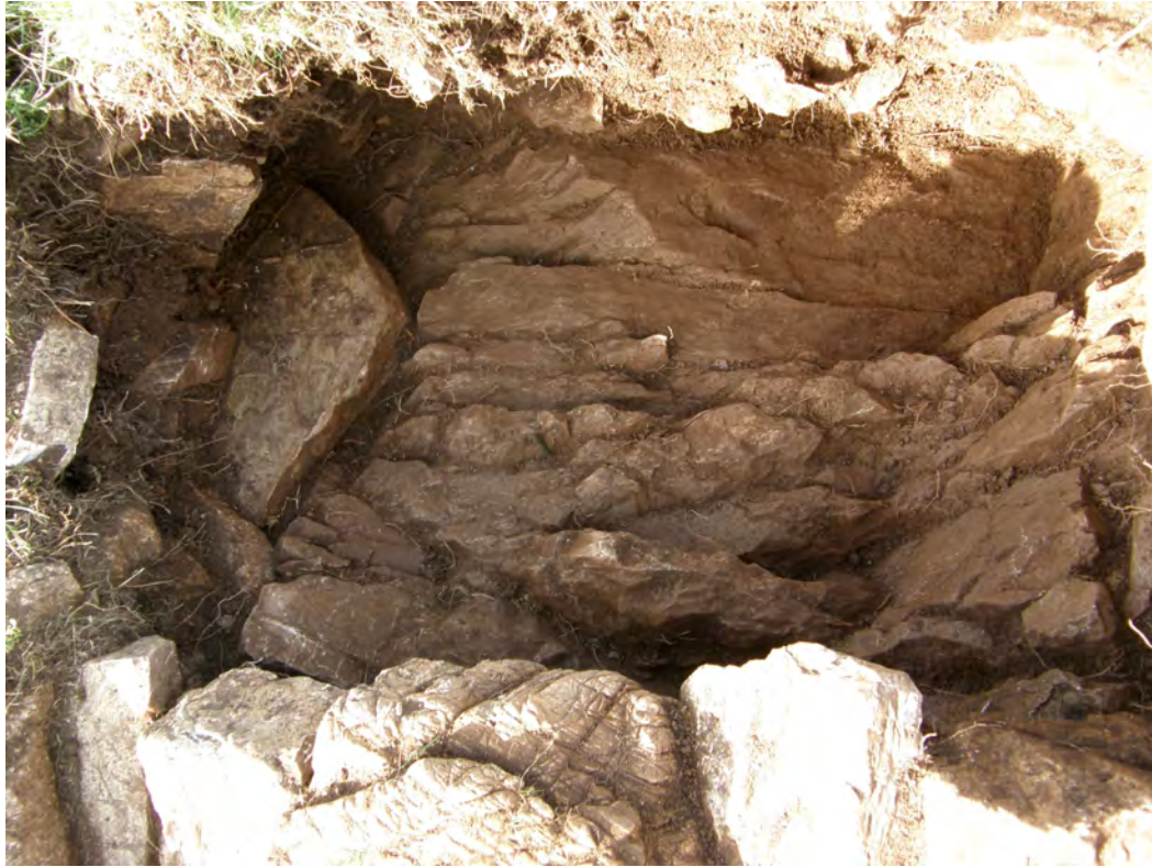
Photo 44 - S12 : substrat calcaire à la base du sondage (photo C. Normand).
