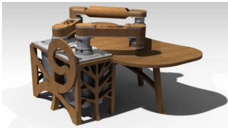
Fig. 1 : CAO du prototype de robot parallèle en bois finale
