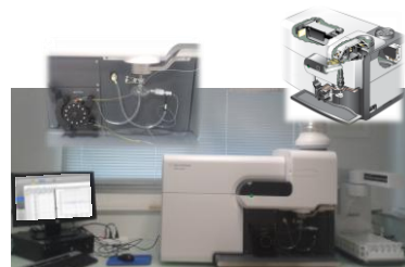
Fig. 2 : Spectromètre d'émission à Plasma micro-ondes MP-AES 4100 AGILENT, CIRAD, UR114 BioWooEB.
