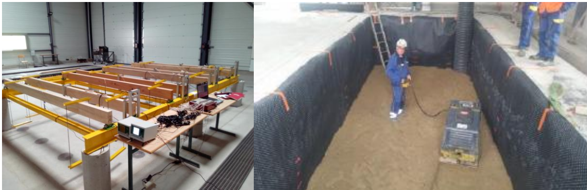
Fig1 : Dalle d'Essai Structures bois et Fosse Chauffée
