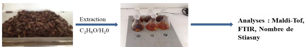
Fig. 1 : Extraction des polyphénols d'acajou.
