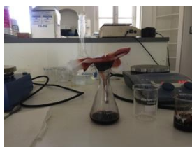
Fig. 1 : Extraction des polyphénols de la sciure d'OKoumé
