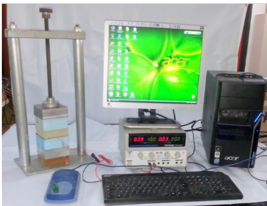
Fig. 1 : Photo du dispositif du plan chaud
