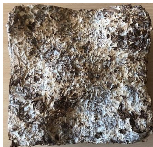
Fig. 9 : Mycocomposite avec du bois recyclé et prétraité – dimensions : 150x150x50mm
