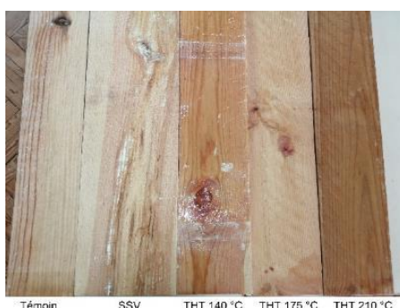
Fig. 2 : Photo des planches séchées et thermotraitées
