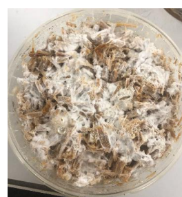
Fig. 6 : Mycocomposite hêtre natif avec ajout d'effluent du traitement hydrothermal.
