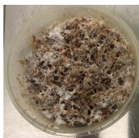
Fig. 5 Mycocomposite hêtre natif sans ajout supplémentaire
