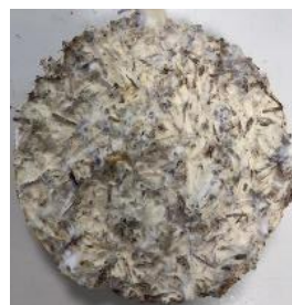
Fig. 2 : Mycocomposite à partir de biomasse prétraité
