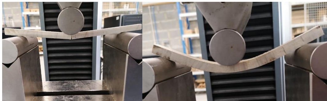
Fig. 4 : Flexion maximum observée lors de l'analyse des baguettes de bois non compressé (à gauche) et compressé à 20% (à droite).
