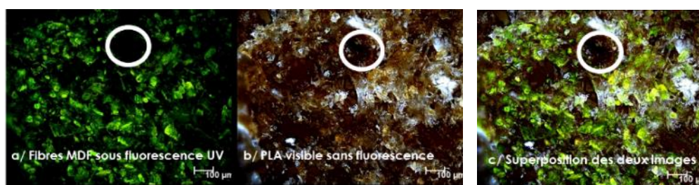
Fig. 2 : Analyse par microscopie d'un pellet du lot C (20% de MDF, pas de séchage) : a) Fluorescence (vert=MDF) ; b) Episcopie fond noir (brun/transparent = PLA), c) Superposition
