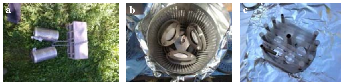
Figure 29. Photographies des POCIS et des SPMD avant leur déploiement Dispositifs utilisés pour l'échantillonnage (a) , Cannister équipé de 3 POCIS (b) , Cannister spider équipé d'une membrane SPMD (c)
