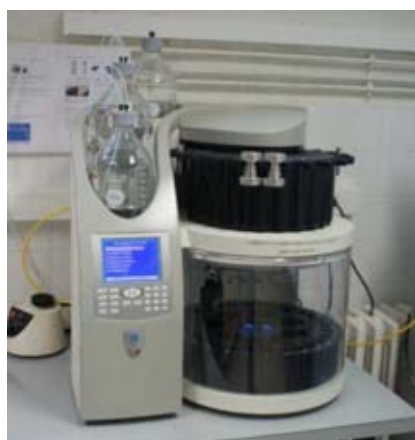
Figure 28. Photographie d'un appareil ASE 350 ® et son principe d'utilisation
