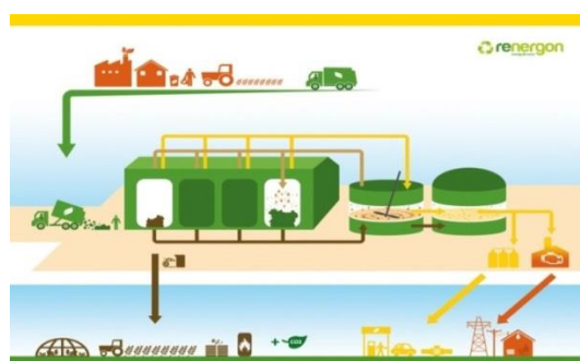
Unité de méthanisation de la ferme de Sockeel (59). Cela permet la production de biogaz à partir de déchets organiques. L'activité agricole a été ici pensée en matière de circularité.
