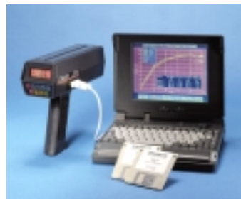
Figure 23. Outil radar utilisé et graphique de validation : régression linéaire quasi-parfaite et ordonnée à l'origine faible (0,06 s) entre les mesures comparées.
