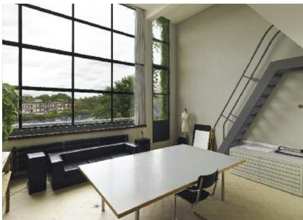
Maison Guiette, Anvers. Vue de l'atelier du dernier niveau. Le volume sur deux niveaux et le grand mur vitré s'inspirent du modèle Citrohan. Etat actuel, maison habitée par un privé. Ph. Kris Vandevorst, octobre 2014.
