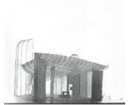
Ci-dessus : Chapelle Notre-Dame-du-Haut, 1950. Les niches du claustra du mur sud sont fermées de verres peints par Le Corbusier. Maquette structurelle de principe en fil de fer habillé de papier (maquette originale). Archives FLC
