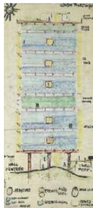
Unité d'habitation, Marseille, 1945. Coupe de principe de l'Unité d'habitation montrant notamment l'encastrement des appartements traversants au-dessus et au-dessous des rues intérieures. Archives FLC 20575.
