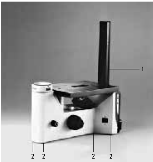
Abb. 6 Stativ mit Durchlichtbeleuchtungssäule 1 Schraube für den Kondensor-Kollisionsschutz, 2 Stativfüße
