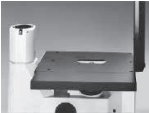
Abb. 24 Objektisch mit angesetzten Verbreiterungen
