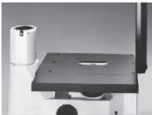
Fig. 24 Platine avec élargissements installés
