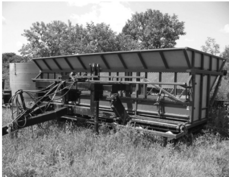
Figure 22. Épandeur de fumier fait sur mesure pour permettre l'épandage de faibles doses de compost (Québec).
