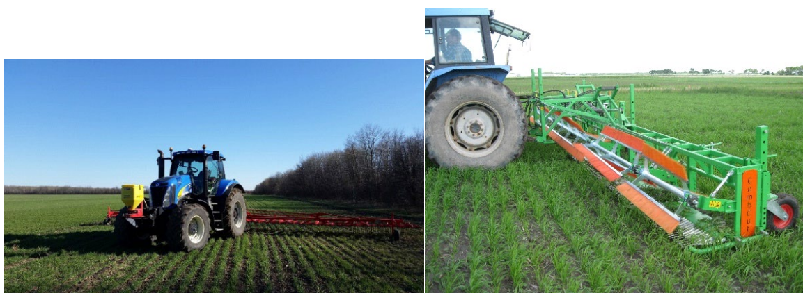
Figure 19. À gauche : Herse à dents avec épandeur rotatif pour cultures de couverture. Références photographiques : S. Beaton. À droite : Combcut. Références photographiques : K. Stanley
