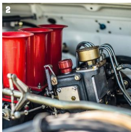
2 Il est presque impossible de reconstruire aujourd'hui un 3.0 RSR avec les pièces originales, comme la pompe à injection spécifique. Sauf lorsqu'on est Gunnar Racing...
