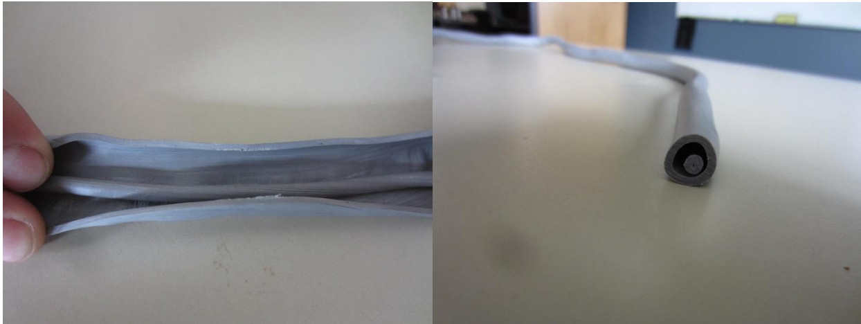
Figure 3-37 : Écoulement balancé provenant de la filière 14 canaux obtenu par refroidissement de la section interne.
