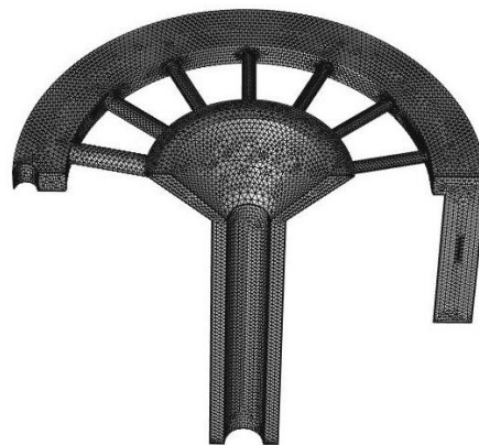
Figure 3-30 : Distribution des éléments tétraédriques dans le modèle d'écoulement de la formulation rapide.
