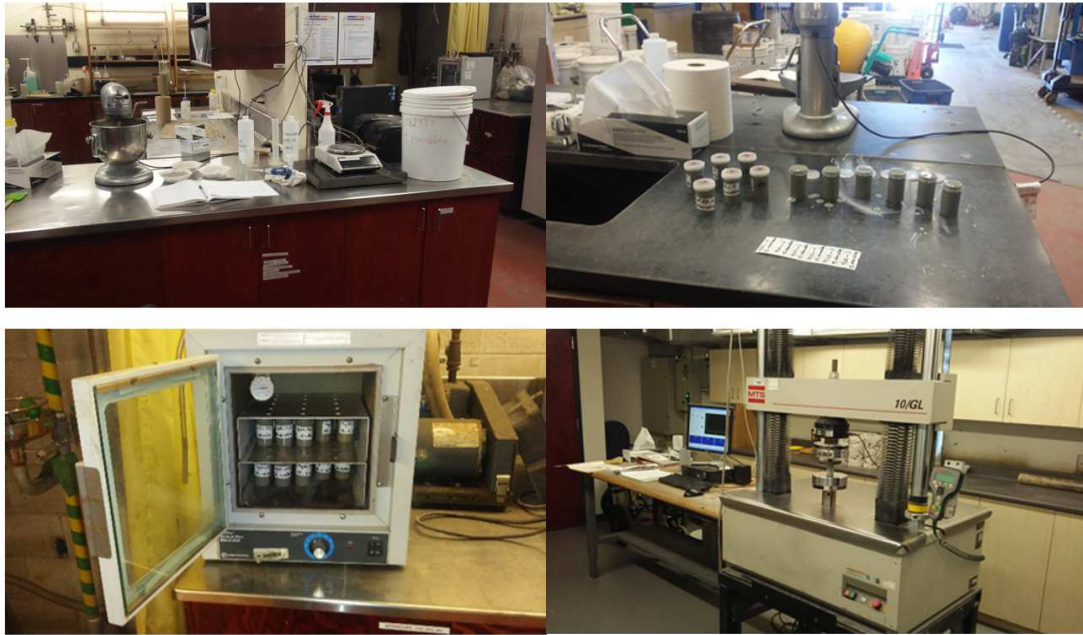
Figure 3.5 Étapes de préparation des remblais et essais mécaniques
