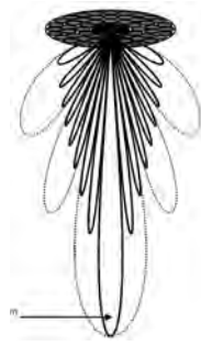
FIGURE 1.22 – Exemple de représentation tridimensionnel d'un faisceau : le lobe principal du centre (indiqué par une flèche) a la plus grande énergie acoustique et cette énergie décroît au fur et à mesure que l'on s'éloigne du lobe principal. Plus la surface d'émission est grande, plus le faisceau est étroit. Figure extraite de Simmonds & MacLennan [2005] .
