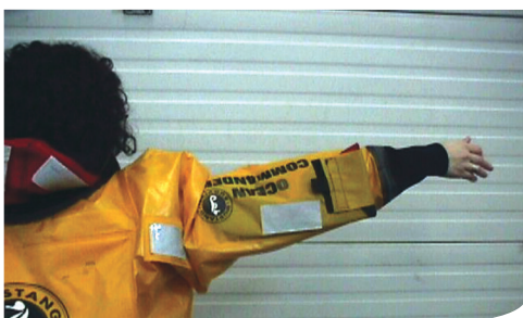
Figure 35 : Exemple de joint de poignet en caoutchouc à remplacement rapide.
