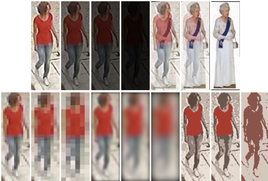
FIGURE 8.2: De gauche à droite: image originale, masque noir d'opacité 0.5, 0.7 et 0.9, morphing d'opacité 0.4, 0.7 et 0.9, pixellisation de taille 3, 5 et 7, flou Gaussian d'écart type 2, 4 et 6 et Kmeans avec un nombre de groupe de 6, 4 et 2.
