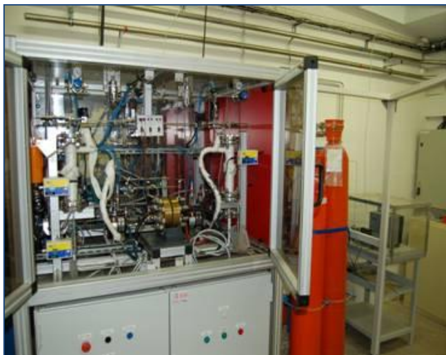
Figure IV-10 : Banc monocellule PEM sous pression – Hélium
