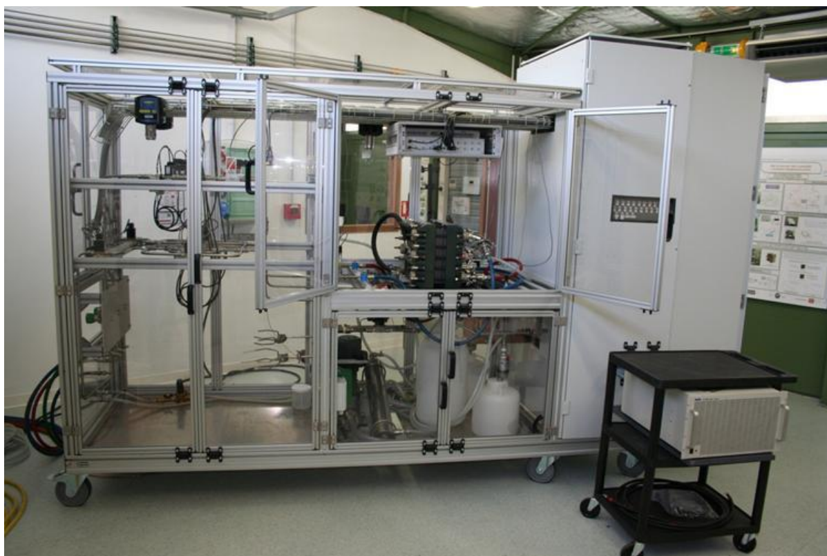
Figure V-20 : Photo du banc PAC « forte puissance » du LAPLACE
