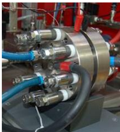
Figure IV-9 : Monocellule Hélion d’une surface active de 25\text{ cm}^2
