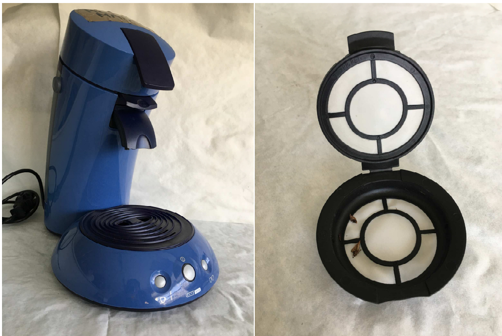
Photographie 4 : Percolateur modifié de type Senseo et filtre échantillon en nylon.
