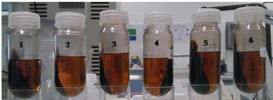
Photographie 6: Extraction des acides fulviques (surnageant, AF2) et humiques (culot, B3).
