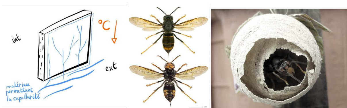
Figure B.2 - Principe proposé à l'issue de l'atelier (nid de Vespa thermorégulé par chaleur latente en plaçant de l'eau devant les cellules de couvées, et absorption de cette eau par les larves par capillarité).
