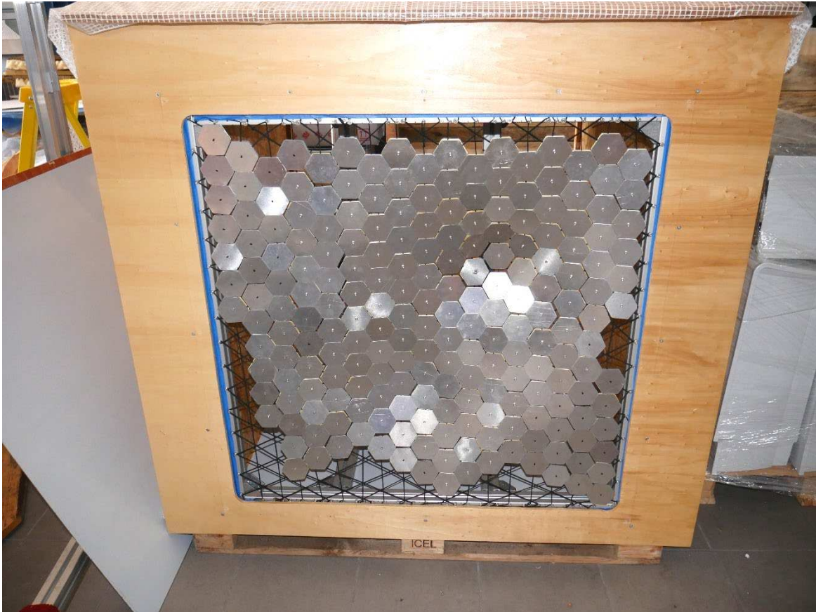
Figure 3.16 - Vue global de la paroi déformable intégrée à une boîte bois.
