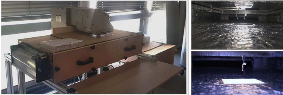
Figure D.1 - Caisse isolée avec ventilateur tangential. Echantillons de 100 mm x 100 mm.
