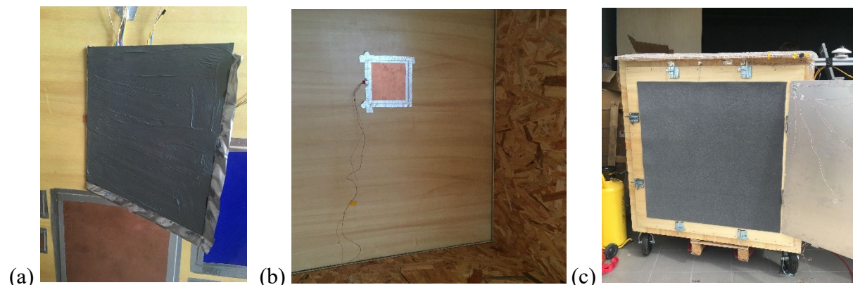
Figure 3.29 - Installation des fluxmètres : (a) pâte thermique déposée sur un fluxmètre, (b) scotch réfléchissant pour la fixation à la surface, (c) fine mousse pour éviter toute couche d'air.
