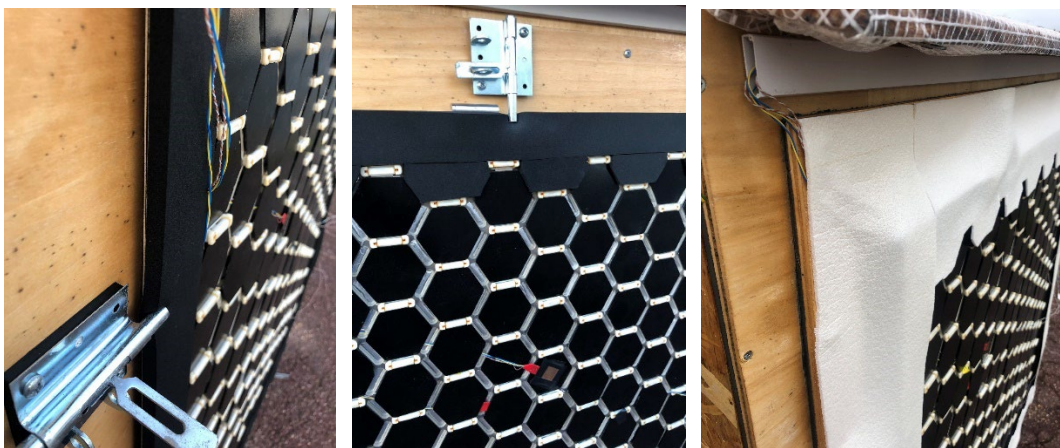
Figure 3.38 - Ajout de mousse noire puis blanches sur le contour aluminium de 4 mm.
