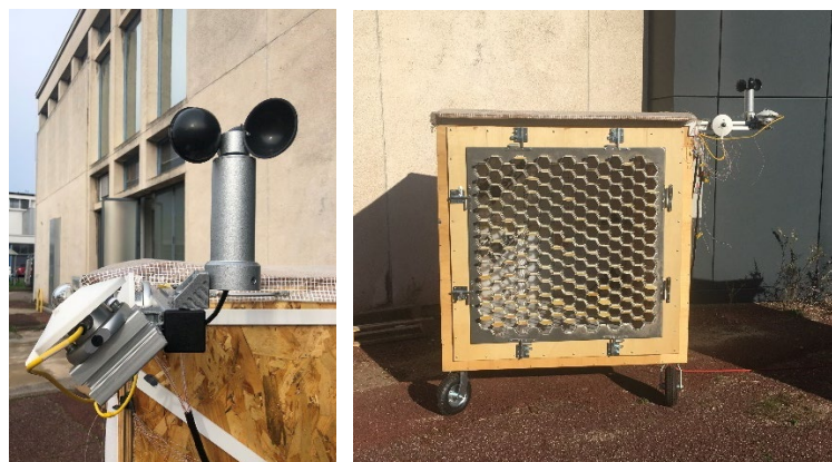
Figure 3.28 - Anémomètre à coupelle fixé sur un profilé aluminium.
