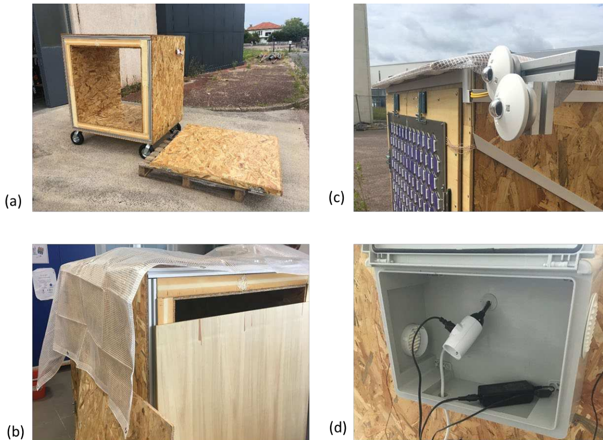
Figure 3.24 - Photographies de la boîte test : (a) séchage de la peinture imperméabilisante, (b) montage et pose de la bâche étanche (c) vue de profil du débord de toit en OBS et bâché, (d) installation du boîtier électrique.
