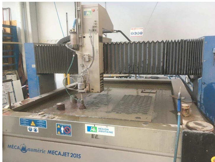
Figure 3.12 - Découpe au jet d'eau du cadre structurel.
