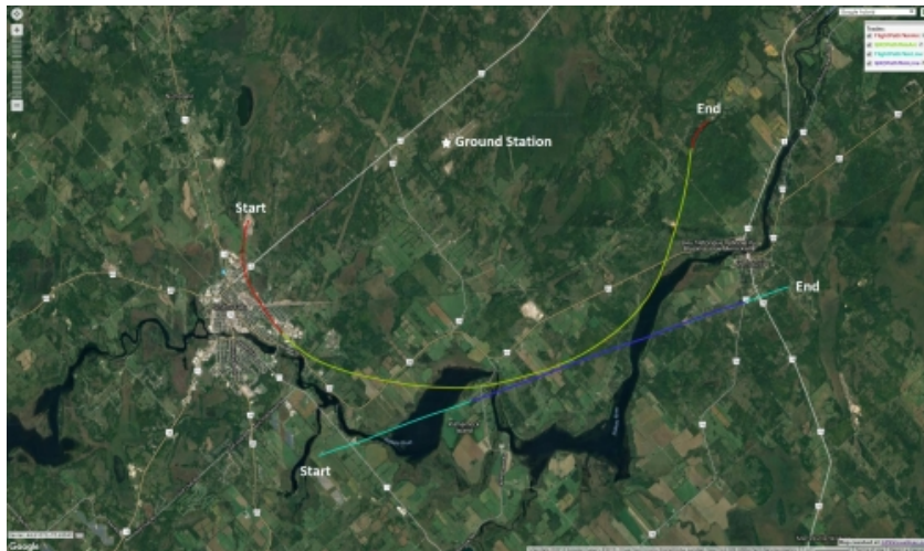
Trajets aériens de 7 km, en arc et en ligne droite, effectués de gauche à droite. L'étoile indique l'emplacement de la station au sol à l'aéroport Montague de Smith Falls. La partie intérieure des traits représente la portion des trajets où la liaison quantique a été active. Photo produite à l'aide de GPSVisualizer.com; données cartographiques : © 2016 Google; imagerie © 2016 Cnes/Spot Image, DigitalGlobe, Landsat, New York GIS, USDA Farm Service Agency.
