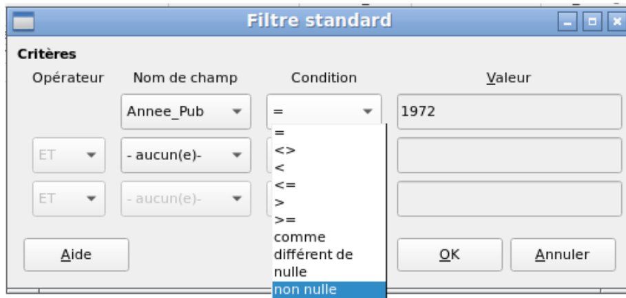
Figure 59: Filtrage par données multiples à l'aide du filtre standard
