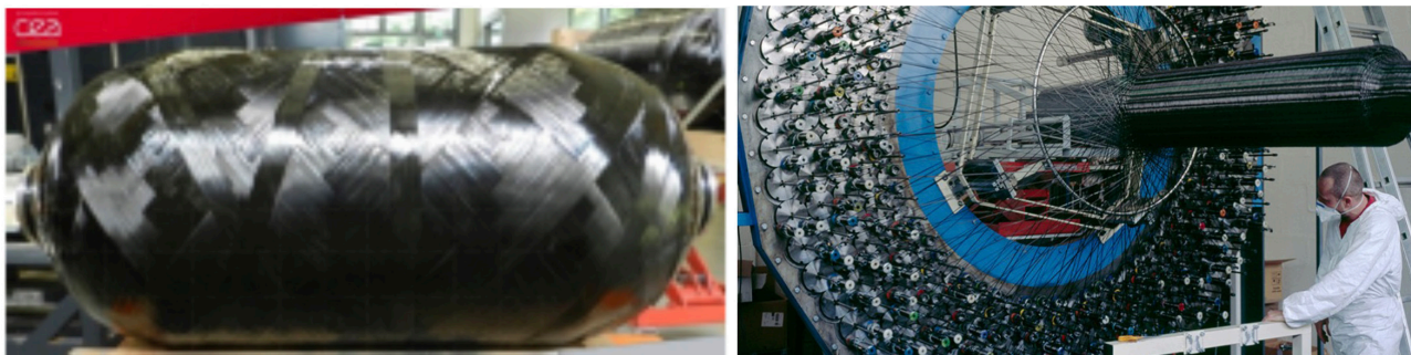
Figure 3 : Réservoir Type IV (liner en polymère) : enroulement filamentaire
