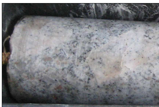
Figure 4 : Photo de carotte du granite de fondation mettant en évidence les cristaux d'orthose blanche
