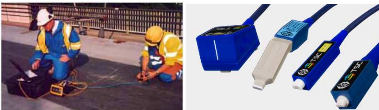
Figure 9 : Aperçu d'une situation de contrôle par ACFM (A gauche) et de sondes du fabricant TSC (A droite).
