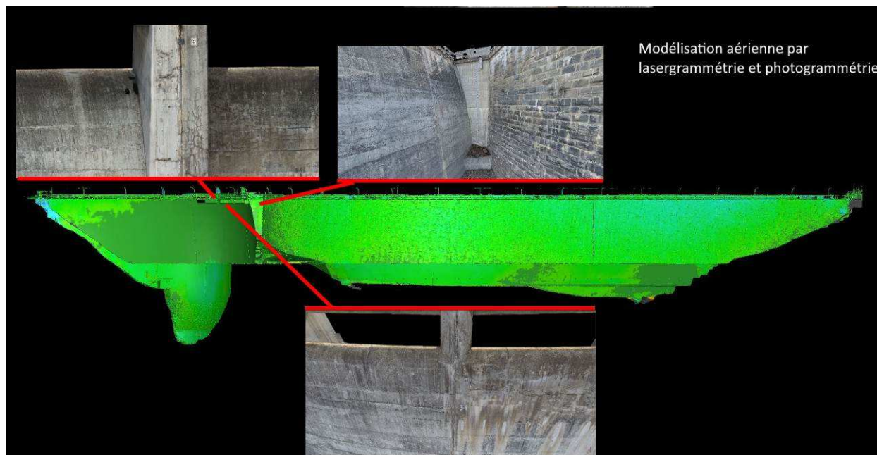
Figure 7 – Modélisation aérienne par lasergrammétrie et photogrammétrie du barrage de Plan d'Aval
