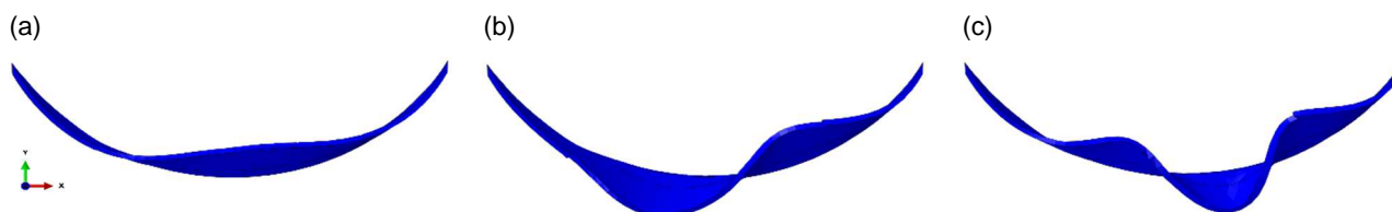
Figure 3 : Déformées modales issues de l'analyse modale sur Abaqus: (a) mode 1, (b) mode 2, (c) mode 3
