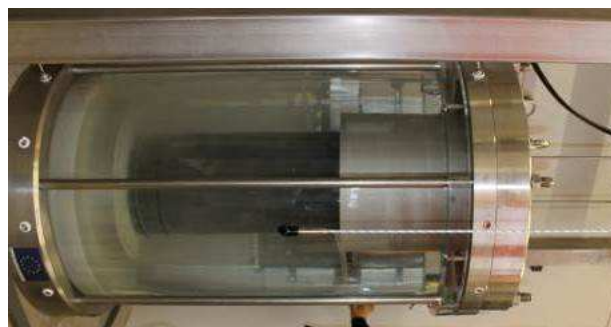
Figure 19 : érodimètre triaxial de grand diamètre du laboratoire GeM
