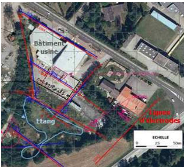
Figure 8 : Plan d'implantation des lignes d'électrodes
