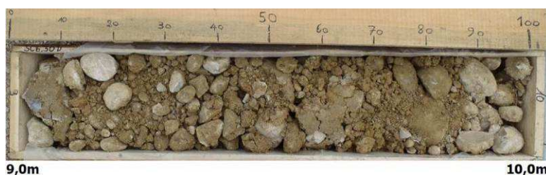
Figure 1 : Echantillon prélevé dans un horizon comportant des éléments fins et des graves de grande dimension
