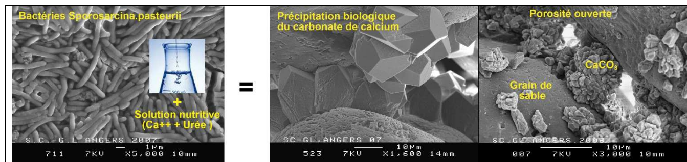
Figure 1 : Principe de la bio-calcification par voie uréolytique.
