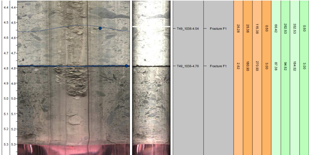
Figure 13 : forage T49-1038 (plot 4/5). Limite de surcarottage à 4,78 m du parement aval (trait bleu rectiligne) qui avait été initialement classée dans la famille RF1 (l'ombre donne l'impression d'une fissure ouverte de 3 mm)
