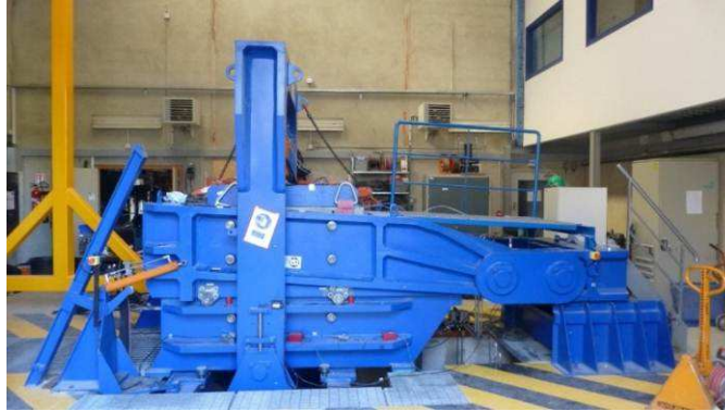
Figure 2 : Machine de cisaillement à grande échelle du CEREMA : « la grande bleue »
