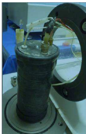
Figure 13 : éprouvette montée et instrumentée
