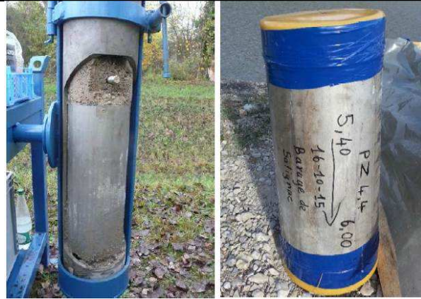
Figure 3 : carottier prototype avec récupération de gaine inox 200mm prélevée
