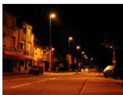
Rue éclairée par des sources au sodium haute pression.
