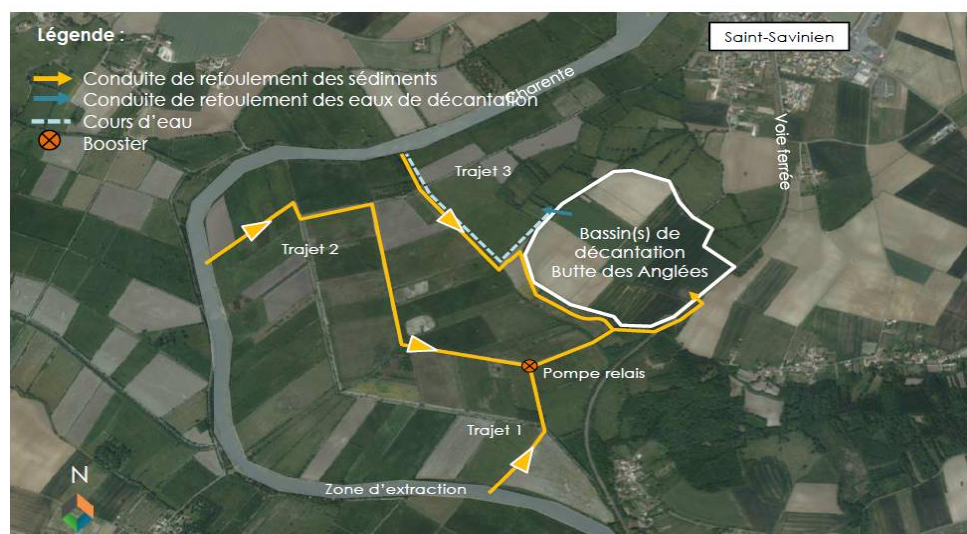
Figure 3. Schéma des principes des conduites d'amenée et de retour en amont du barrage
