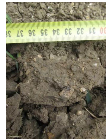
☞ Photographie 160 : S9 : Légères traces d'oxydation visibles à partir de 33 cm (Biotope, 2016)
